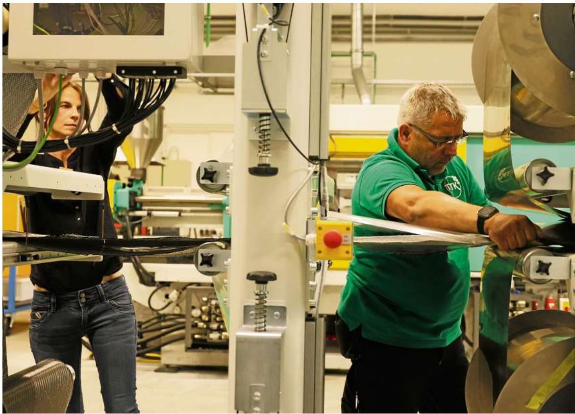
Am TITK, dem Thüringischen Institut für Textil- und Kunststoffforschung, werden am Donnerstag unterschiedliche Materialien als Folien für das Pressen von Formen vorbereitet. FOTO: KAI MUDRA
