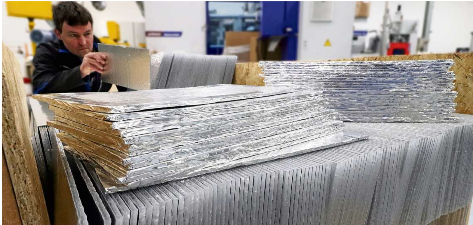
Die bei Smartpolymer entwickelte Folie für Transportboxen kann Temperaturen bis plus 82 Grad halten.
