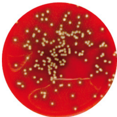
TPE-Spritzgussplatte, unbehandelte Kontrolle: nicht antibakteriell (oben); TPE-Spritzgussplatte mit hbp-Ag-Additiv: antibakteriell (unten)
