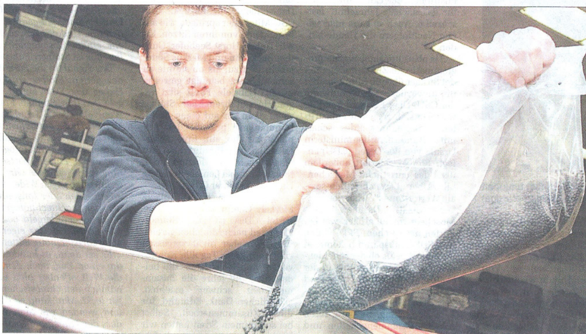
Mike Röske, wissenschaftlicher Mitarbeiter im Thüringischen Institut für Textil- und Kunststoffforschung in Rudolstadt, füllt einen thermoplastischen Kunststoff für Verarbeitungstests in eine Spritzgussmaschine. (Foto: OTZ/Peter Scholz)
