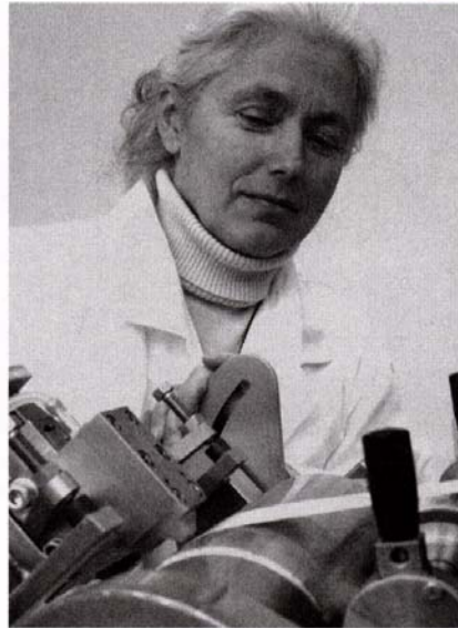
Justieren des Antragswerkes für eine Schmalspannbeschichtung Foto: TITK
