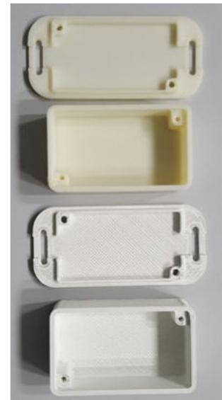
*Dielektrisch gefülltes Filament und 3D-Druck auf eine Dipolantenne und gedruckte Gehäuse für die Aufnahme einer Antenne.*
