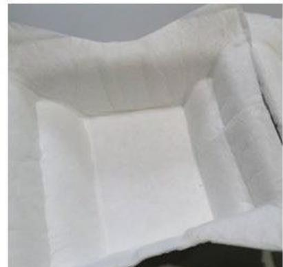
Bild links : Formteilpresse im TITK zur Verformung von getränkten/besprühten Melamin-MB-Vliesen. Bild rechts: 3D verformtes Melamin-MB-Vlies (Oberseite, Unterseite)
