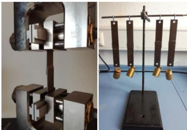
Bestimmung der Klebeeigenschaften im Zugversuch mit der Zwick Z005 (links) und der Wärmestabilität gemäß des Shear adhesion failure tests (rechts).
