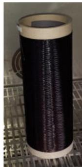
*Dunkelfärbung der mit Ammoniumiodid beladenen PVOH-Filamente bei der Stabilisierung ab  $150 \text{ }^\circ\text{C}$*
