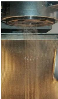
*Schmelzspinnen von Polyvinylalkohol und Ammoniumiodid zu Filamenten*
