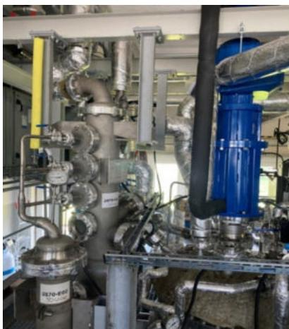
*Isolierung des Hauptreaktors nach dem Heißvakuumtest*
