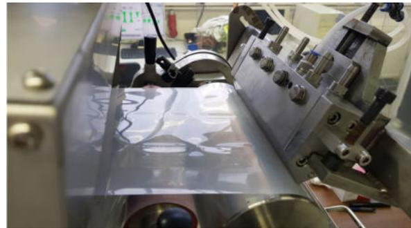
*R2R-Coating: Nassantrag mittels Schlitzgießer (Slot-Die) einer Perhydropolysilazan-Formulierung (PHPS) auf PBS-Folie zur kontinuierlichen Erzeugung einer  $\text{SiO}_x$ -Barrierschicht*
