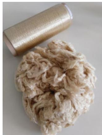
*Stapelfaser und Filamentprobe, hergestellt aus schäbenbasiertem Hanfzellstoff*
