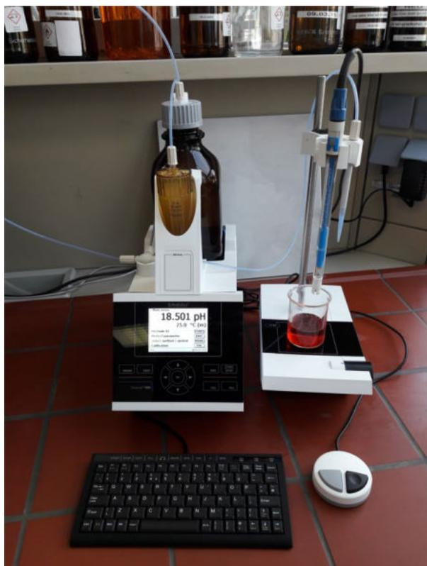
Das neue Gerät für die potenziometrische Titration.
