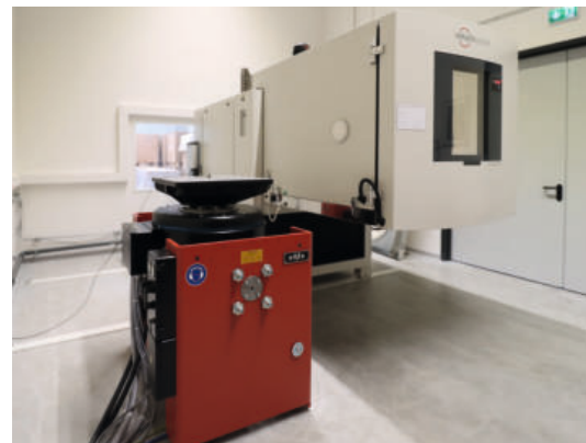
Der Vibrationsprüfstand (links) und die Klimakammer (rechts) können in Kombination benutzt werden.
