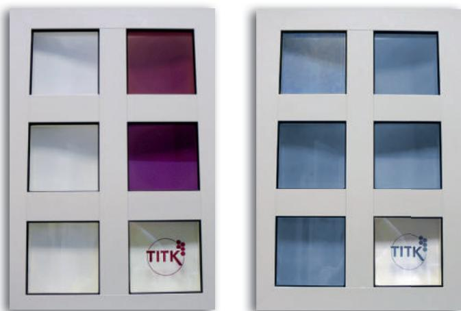
**Multielektrochromes Modul und seine optische Charakteristiken / Multielectrochromic module and its optical characteristics**
