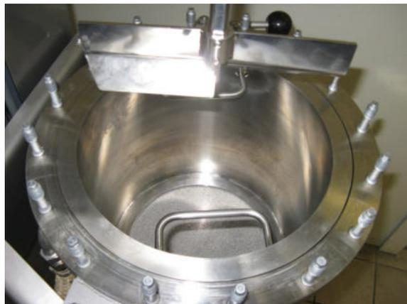
*Links: Druckfiltrationsanlage Druckfilter 20 Liter, inkl. KiloClave-Gestell mit Lift- und Schwenkvorrichtung, temperierbar, max. Druck: 6 bar, Filterplatte austauschbar. Deckelplatte mit 2 Triclamp DN15.*
