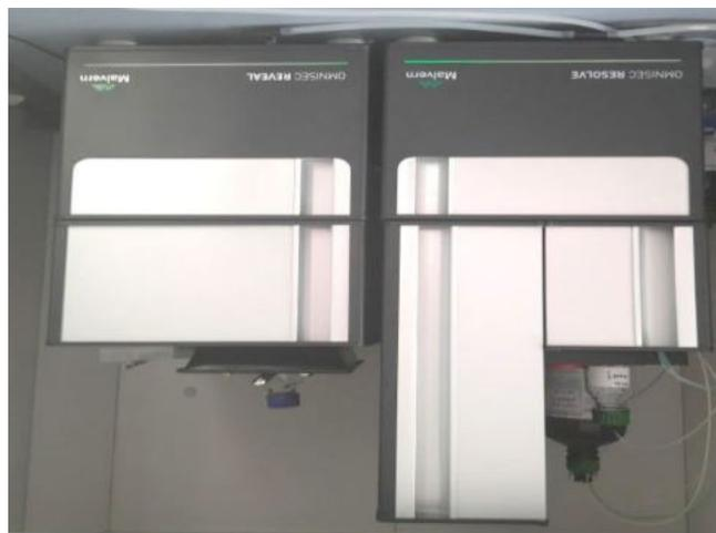
*OMNISEC-System mit RI-Detektor, RALS/LALS-Detektor, UV/PDA-Detektor und einem Viskometer von Malvern Panalytical.*
