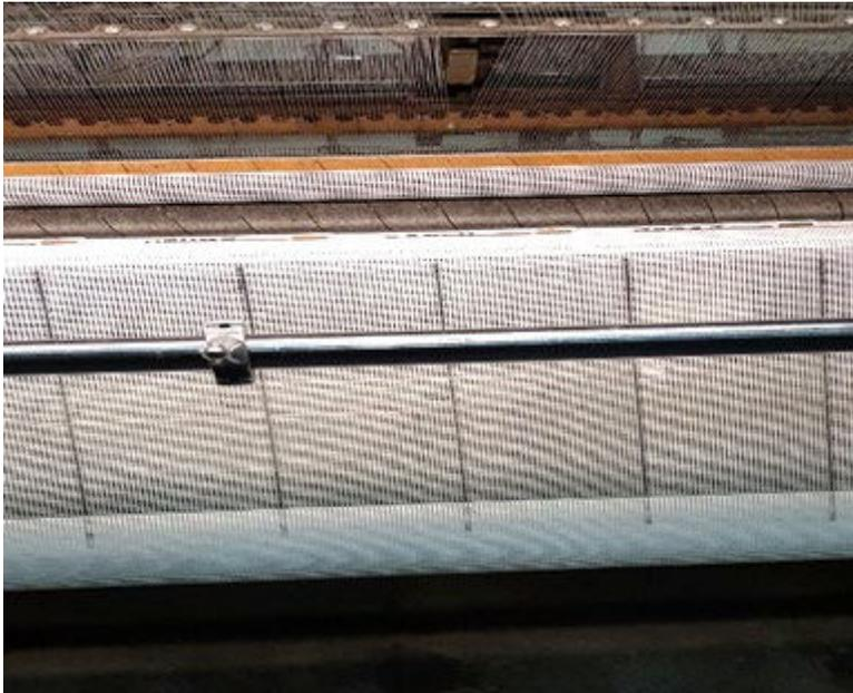
*Struktur eines Adsorptionstextils für die Wasser- und Abwasserreinigung. (Foto: Rühr GmbH)*
