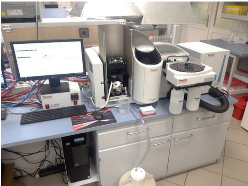
*Atomabsorptionsspektrometer (AAS) ICE 3500 und Peripherie zur Bestimmung der Elemente im Ultraspurenbereich mittels Flammen-, Graphitrohr- oder Hydrid Technik.*
