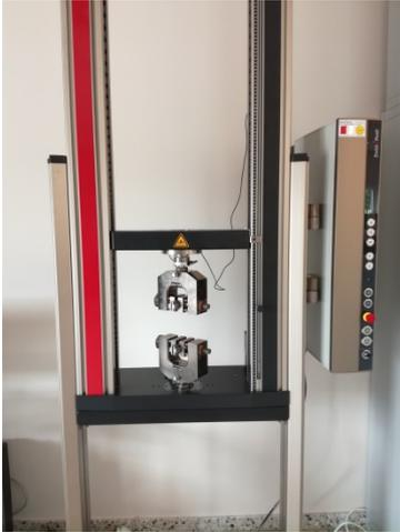
Die Material-Prüfmaschine ist speziell für Zug, Druck- und Biegeversuche, Scherung und Torsion konzipiert, sodass sie sich hervorragend bei anspruchsvollen Aufgaben in der Material- und Bauteilprüfung einsetzen lassen. Durch die vielfältigen Ausstattungsmöglichkeiten können Kunststoffe, Elastomere, Metalle, Verbundmaterialien, Papier, Pappe, Textilien, Schaumstoffe, Nahrungsmittel oder Bauteile/Komponenten geprüft werden.
