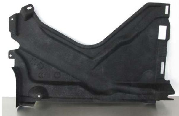
Bild 1: LWRT Bauteil aus vernadelten Faservliesen
