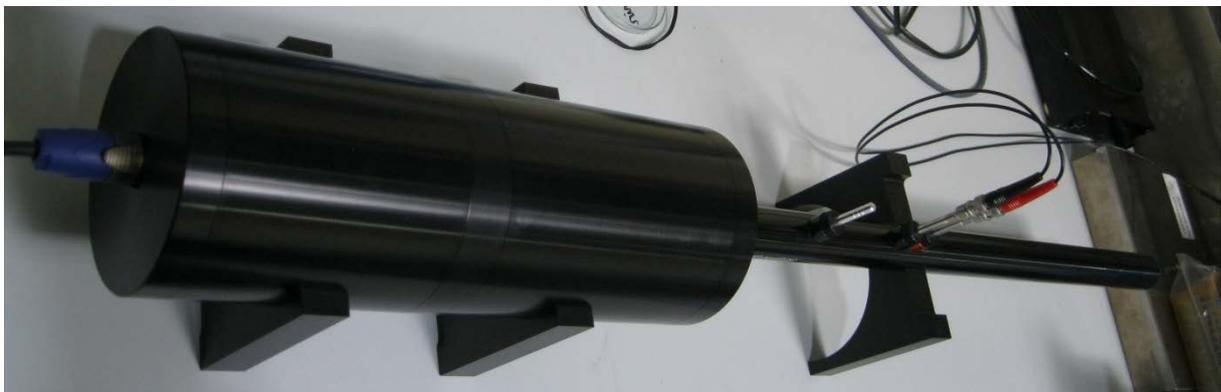
Im Impedanzrohr wird eine ebene Schallwelle gegen eine schallabsorbierende Materialprobe vor einem schallharten Abschluss ausgesendet und der resultierende Schalldruck mittels zwei vor der Materialprobe befindlichen Mikrofonen gemessen. Durch Auswertung der einfallenden und reflektierten Schallenergie lässt sich anschließend das Schallabsorptionsvermögen des Materials bestimmen.
