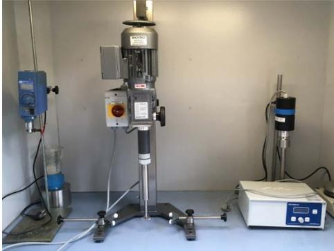
Der Laborrührer LR 34 der Fa. Disperlux ist ein leistungsfähiges Gerät zum sicheren Dispergieren von Pulvern in flüssige Medien. Das Rührwerk kann im Technikumsbetrieb auch für Ansätze bis zu 10 Liter eingesetzt werden. Es deckt mit einem Drehzahlbereich von 465 bis zu 4.200 Umdrehungen pro Minute ein weites Anwendungsfeld ab und ermöglicht die sichere und reproduzierbare Herstellung von Dispersionen.
