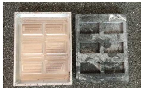
Abbildung: an das zu kühlende Bauteil (links) anpass- sowie formbare PCM-Polymercompound (rechts)
