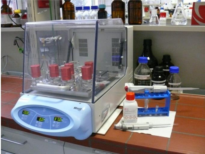
**Abb. 1:** Enzymatische Behandlung von PET-Varianten im Inkubator
