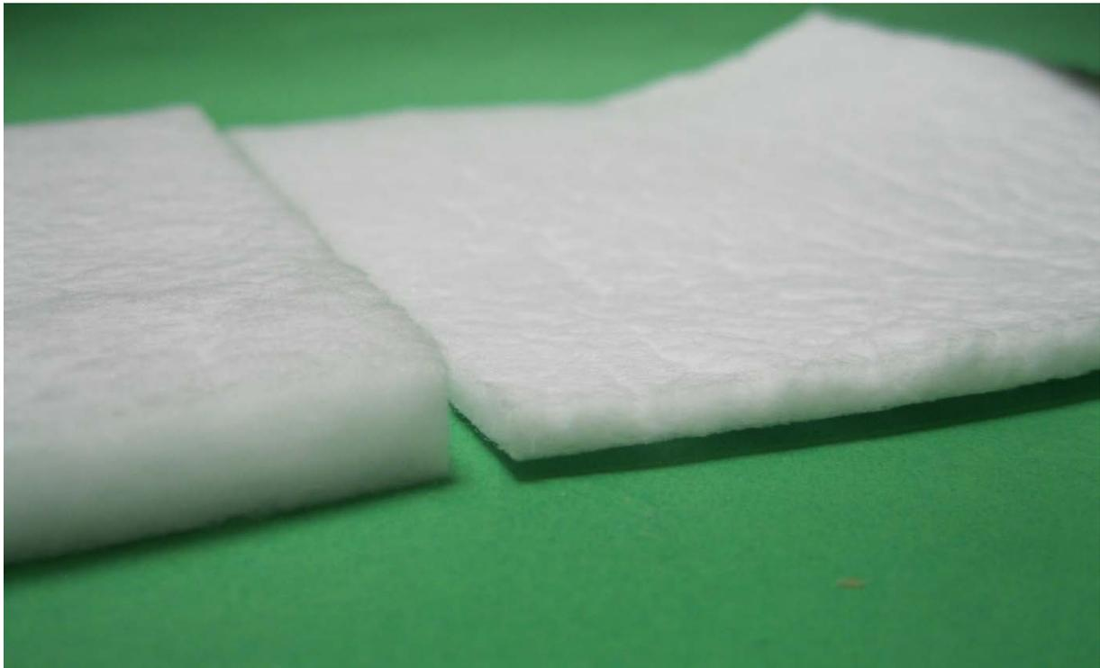
*Melaminharz-Spinnvliese: Vergleich Trommel-Ablage (links) und Siebband-Ablage (rechts)*
