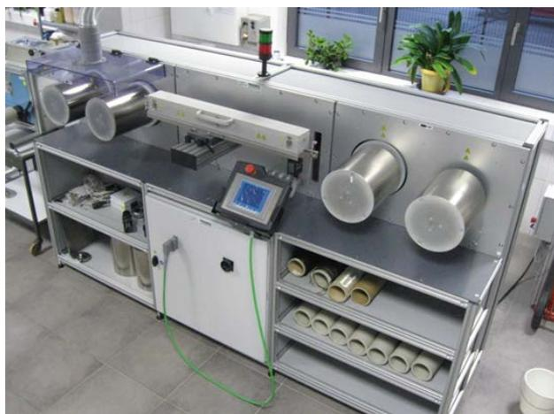
*Trockenmodul mit induktions-geheizten Doppelwalzen, Heißluft-Verstreckkanal und Abzugswalzen zur Herstellung hochfester PAN-Fasern*
