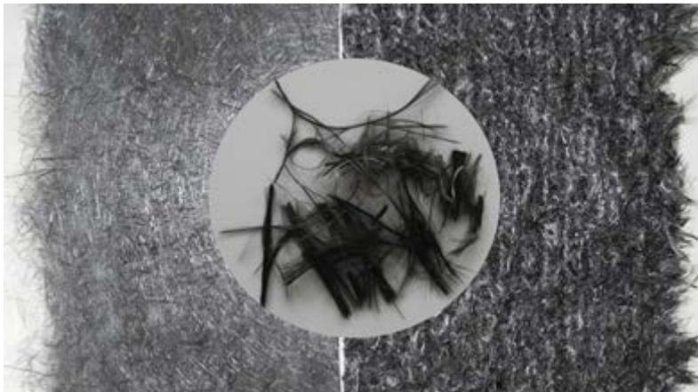
*Halbzeugmatten aus Recyclingkarbonfasern mit maßgeschneiderten Faserorientierungen für die Verstärkung Kunststoffmatrices*
