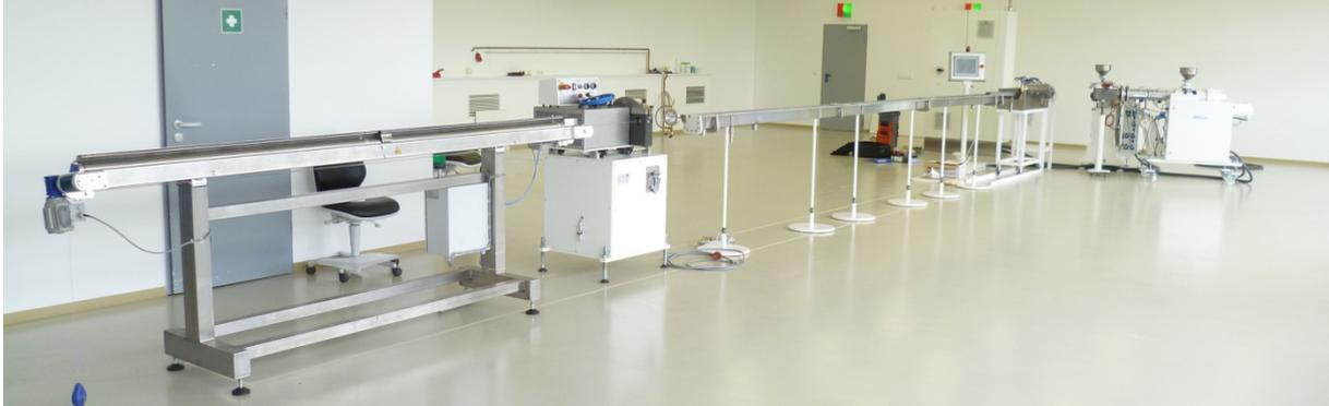
Katheterextrusionsanlage für medizinische Schläuche (Fa. EMATIK, Bild: EMATIK)
