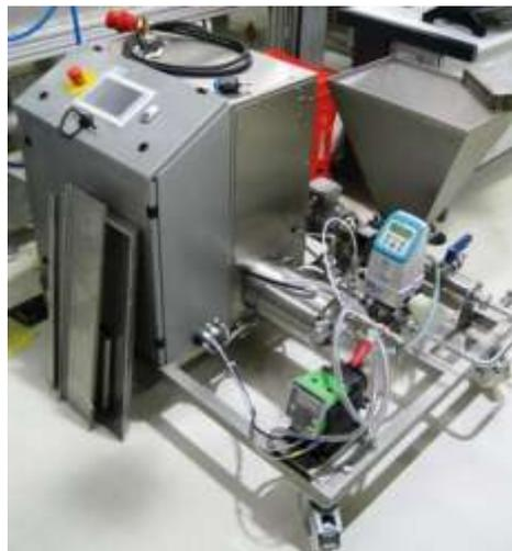
Abbildung 2: Dynamischer Schaumgenerator Hansa Mixer Top-Mix Compact zum kontinuierlichen Verschäumen von (niedrig)viskosen Flüssigkeiten mittels Luft oder Stickstoff
