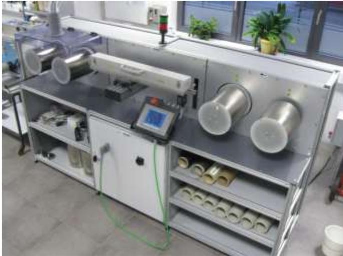
Besteht aus einem beheizten Galettenduo, einem Heißluftverstreckkanal, einem unbeheizten Galettenduo, eine Punktabsaugung der Trocknerabluft und autarker SPS-Steuerung mit Datenschnittstelle zur Steuerung einer vorhandenen Faserspinnlinie.
