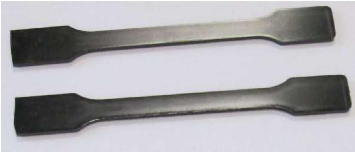
Abbildung: Prüfkörper aus einem MWMT-Verbundmaterial zur Untersuchung von mechanischen Werkstoffeigenschaften
