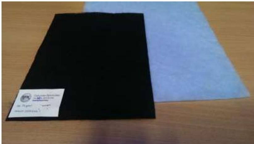
Abbildung: Faservliese unter Verwendung von neuartigen Celluloseadsorberfasern
