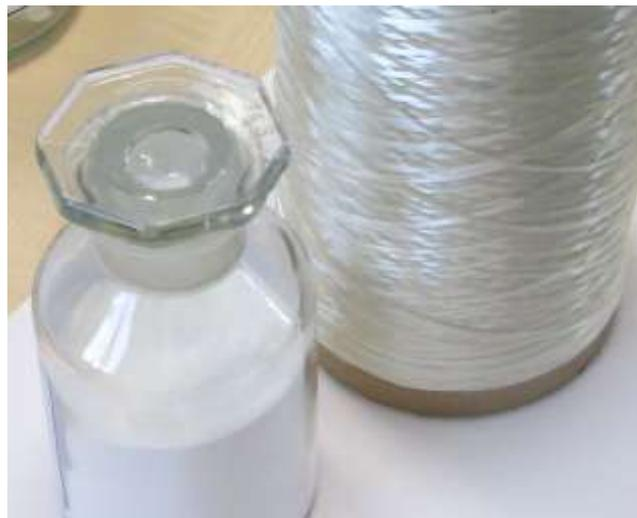
Abbildung: Polyacrylnitril Pulver und Precursorspule
