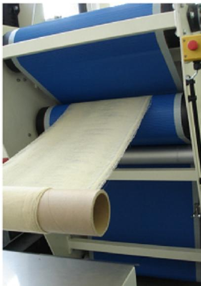
*fertiges Vlies nach dem Trocknungsprozess*
