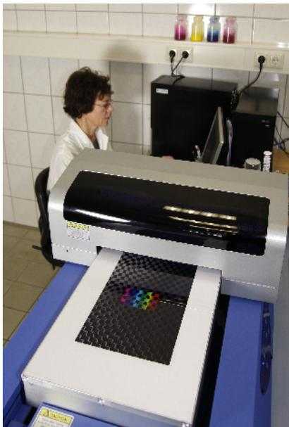
Der Freejet 320+ ist ein Digitaldrucker und basiert auf der Piezo-Tintenstrahltechnik. Er arbeitet mit speziellen wasserbasierenden, thermisch härtenden Pigmenttinten. Diese zeichnen sich neben ihrer Umweltfreundlichkeit durch ausgezeichnete UV-Beständigkeit und hohe Abriebfestigkeit aus. Maximale Druckgröße ist 330 mm x 520 mm.
