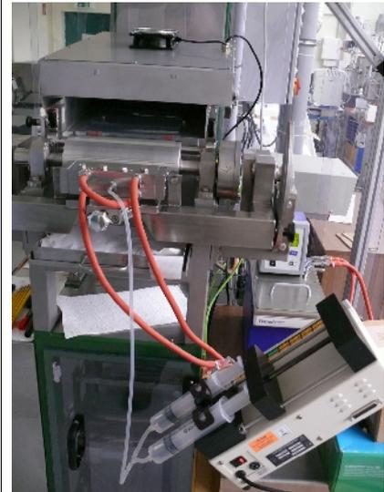
Abbildung 1: R2R-EVAL-Beschichtung: Antrag einer 10 m% DMF EVAL-Lösung 2 m/min auf PET-Rollenware an LBA200 mit Vordosierung und Thermostat zur Beheizung des Gießers
