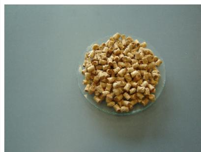
Granulate beladen mit Eisenhydroxid
