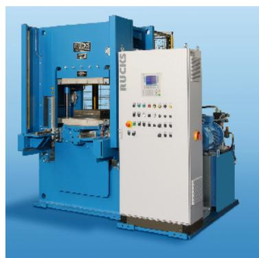
Die Laborpresse ermöglicht die Herstellung von faserverstärkten Kunststoffen mit thermoplastischer oder duroplastischer Matrix und erweitert die bereits vorhandenen Möglichkeiten im Faserverbund-Technikum des TITK. Die Presse verfügt über heiz- und kühlbare Platten und hat eine nutzbare Aufspannfläche von 900 x 600 mm. Dadurch können auch Musterbauteile gefertigt werden.
