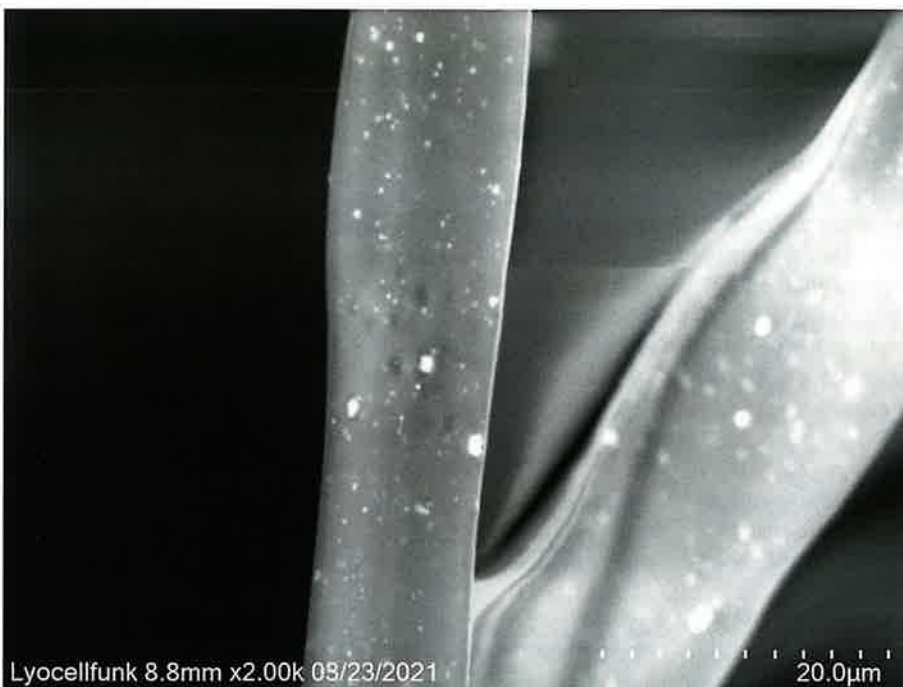
Abb. 4 Mikroskopische Aufnahme einer Lyocell-Faser additiviert mit 2 % Titandioxid
