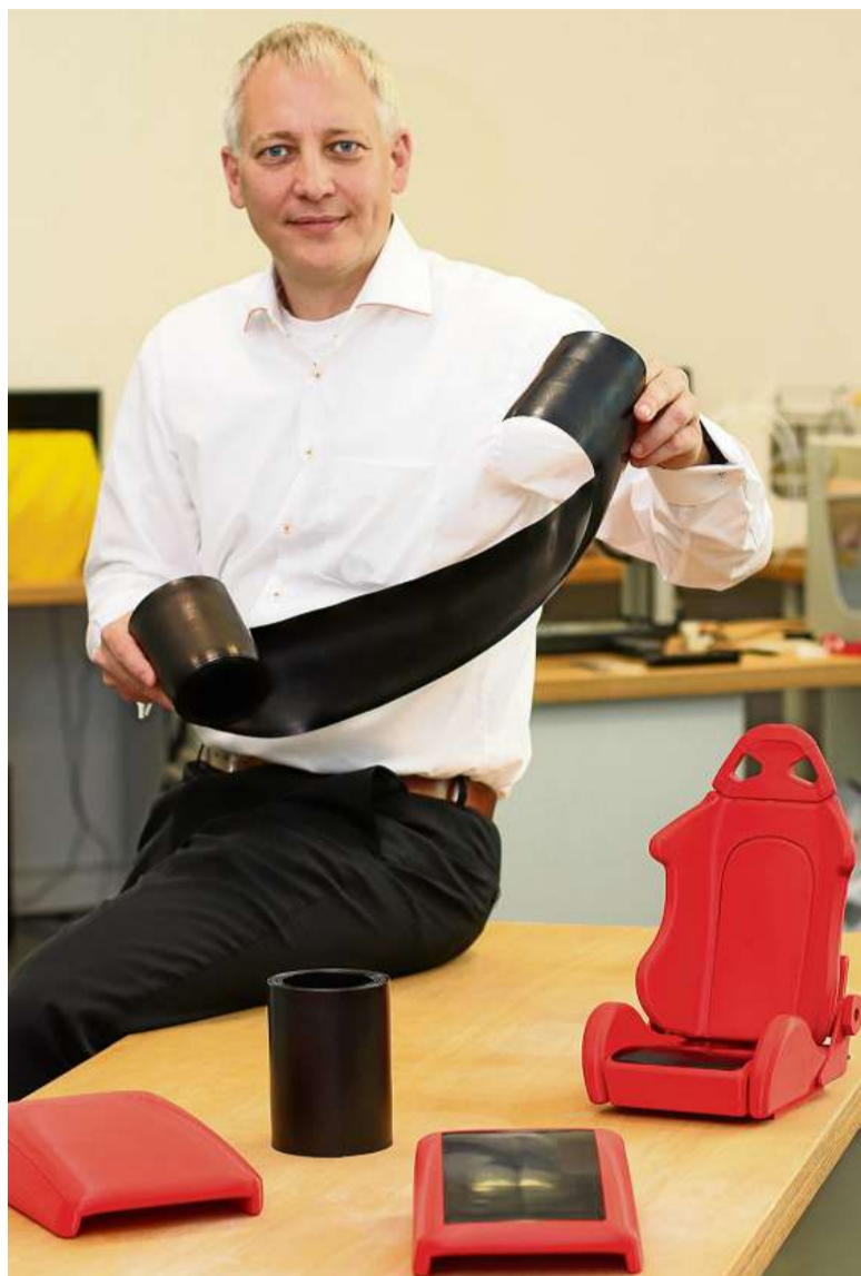
Institutsdirektor Benjamin Redlingshöfer zeigt eine Rolle der metallfreien und selbstregulierenden Heizfolie. Auf dem Tisch stehen Anwendungsbeispiele aus dem 3D-Drucker - ein Autositz-Modell und eine Pkw-Mittelarmlehne mit und ohne Heizfolie.
