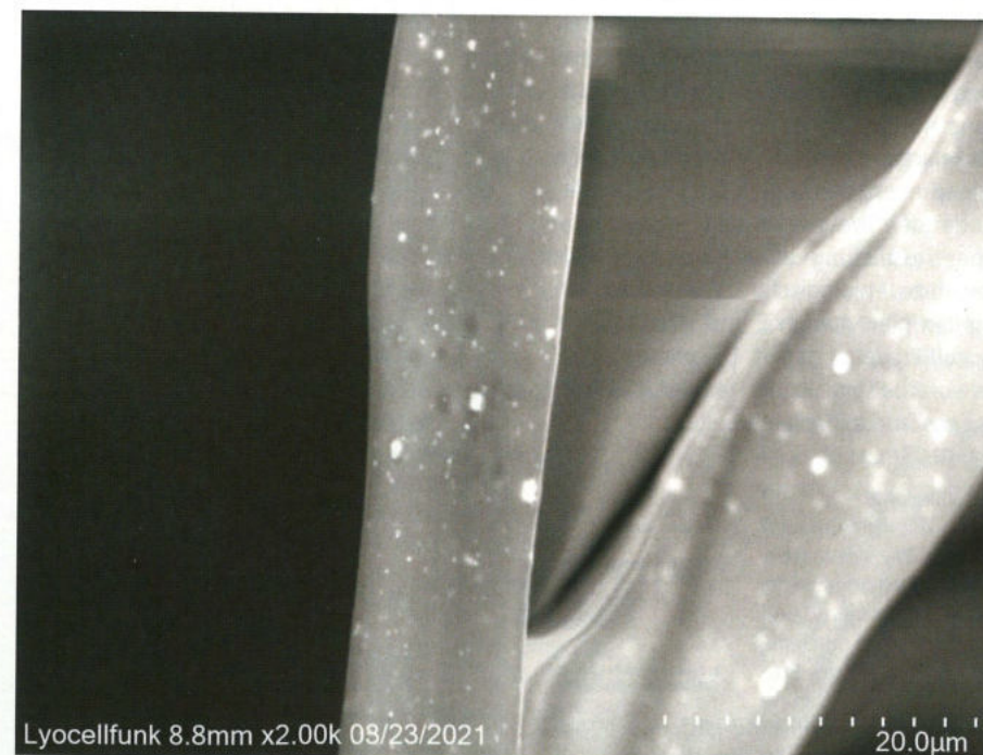
Abb. 4 Mikroskopische Aufnahme einer Lyocell-Faser additiviert mit 2 % Titandioxid
