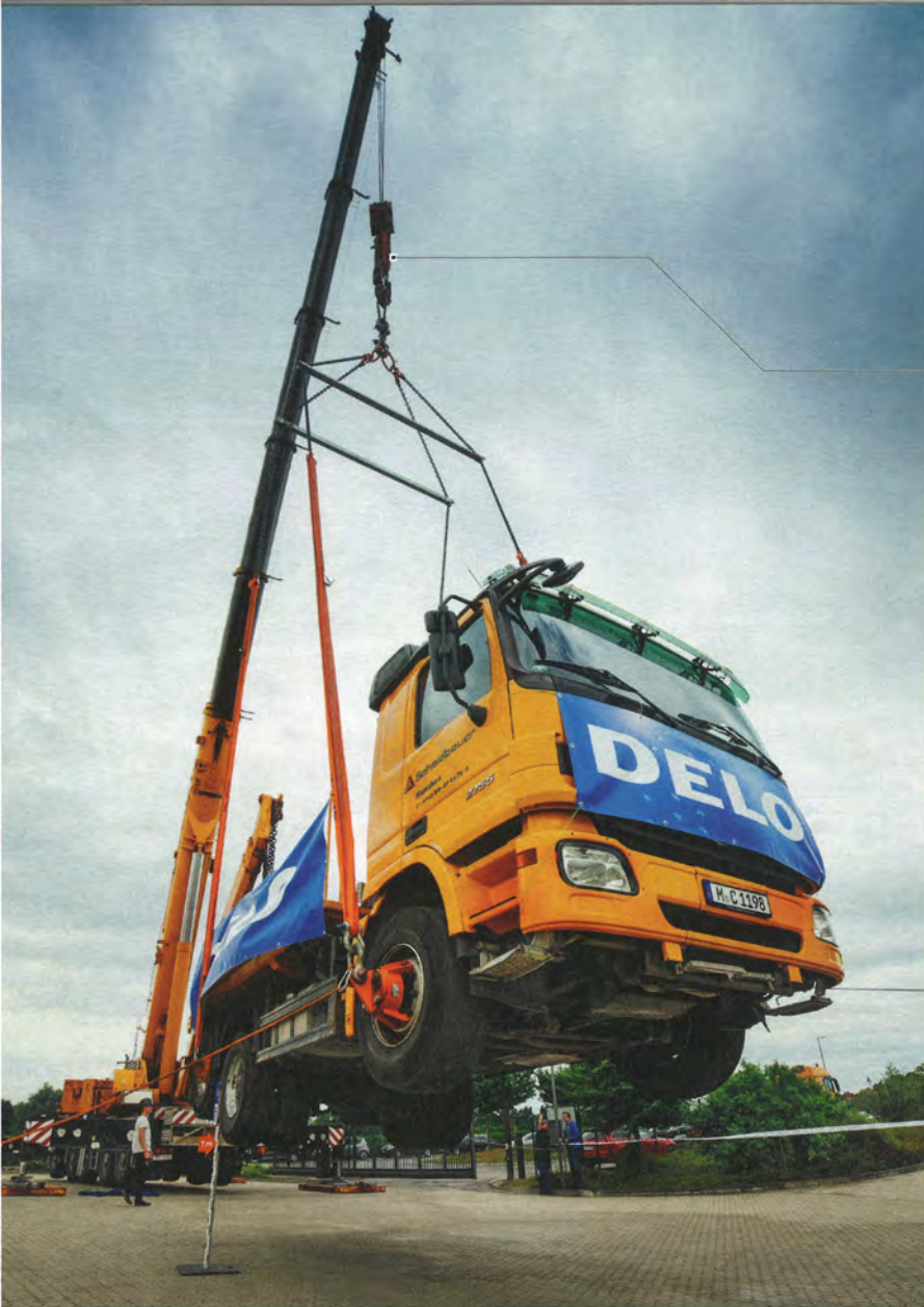
Drei Gramm Epoxidharzkleber zwischen zwei Aluminiumzylindern trugen beim Weltrekord der Firma Delo das Gewicht des schwebenden Lkw: 17,5 Tonnen. Die rot lackierten Verbinder aus Metall dienten lediglich der Sicherheit.
