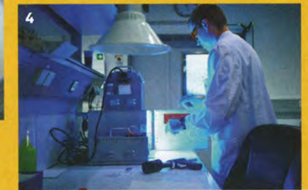
1 In Bottichen werden bei Delo die Komponenten eines Klebstoffs gemischt. 2 Im Labor der Firma werden jährlich Tausende neue Kleber entwickelt. 3 Viele davon werden unter langwelligem gelbem Licht produziert. 4 Der Grund: Kurzwelliges Licht im UV-Bereich setzt die Aushärtung in Gang.
