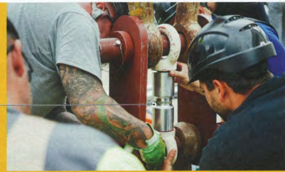
Drei Gramm Epoxidharzkleber zwischen zwei Aluminiumzylindern trugen beim Weltrekord der Firma Delo das Gewicht des schwebenden Lkw: 17,5 Tonnen. Die rot lackierten Verbinder aus Metall dienten lediglich der Sicherheit.
