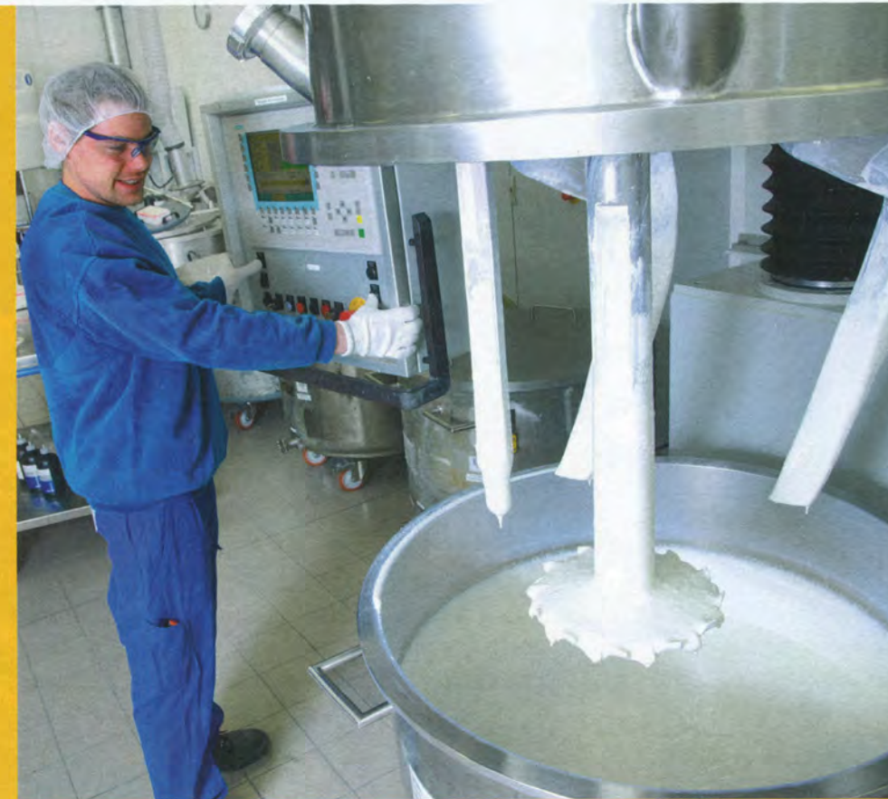
1 In Bottichen werden bei Delo die Komponenten eines Klebstoffs gemischt. 2 Im Labor der Firma werden jährlich Tausende neue Kleber entwickelt. 3 Viele davon werden unter langwelligem gelbem Licht produziert. 4 Der Grund: Kurzwelliges Licht im UV-Bereich setzt die Aushärtung in Gang.
