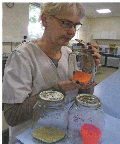
Laborantin Sigrun Bayer ist eine von mehr als zehn Geruchsprüfern beim TITK-Tochterunternehmen OMPG in Rudolstadt, die Kunststoffbauteile auf Geruch prüfen. Foto: TITK
