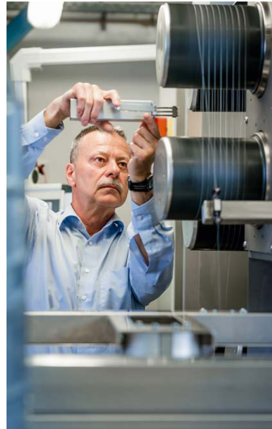
Dr. Rüdiger Strubl prüft an der Schmelzspinnanlage die Fadenspannung im Verstreckprozess. Foto: TITK
