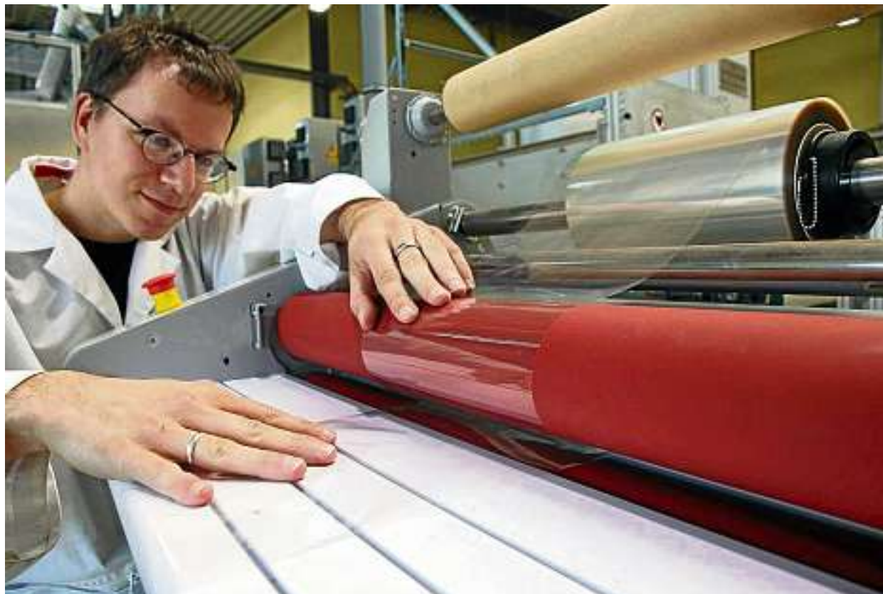
Michael Schöbitz, Projektleiter am TITK in Rudolstadt, bestückt ein Industrie-Laminiergerät mit zwei Verpackungsfolien, die auf dieser Anlage mit einem biologisch abbaubaren Klebstoff verbunden werden. Foto: TITK/Steffen Beikirch
