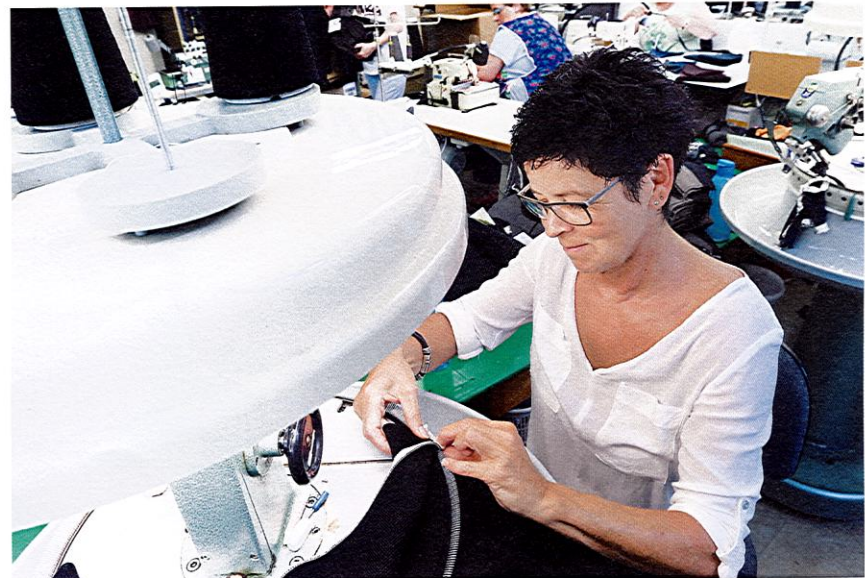
Ketteln Eine Mitarbeiterin der Strick Zella GmbH schließt und verbindet die Maschen verschiedener textiler Flächen. Eine präzise Handarbeit, die viele Jahre Erfahrung braucht und einen essenziellen Qualitätsmaßstab bildet
