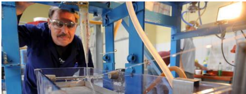
Harry Müller überprüft eine Spinnanlage. Sie stellt Fäden mit eingelagertem Vitamin E her. Kleidungsstücke mit der Faser sollen das Vitamin an die Haut abgeben.
