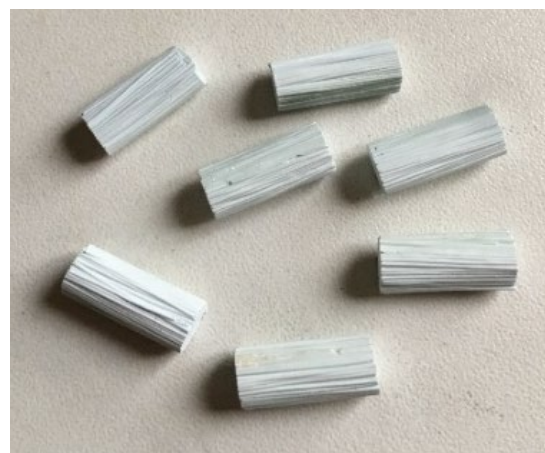
gesinterte, einsatzbereite Knochenersatzmaterialien
