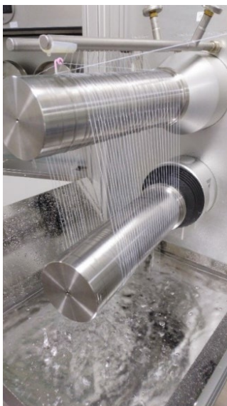
Filamentwäsche bei der Polyglucanfilamentherstellung
