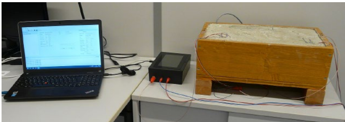
Funktionsmuster mit Messsystem und eingebetteter Sensorik zur akustischen Analyse der Festigkeitsentwicklung des Frischbetons
