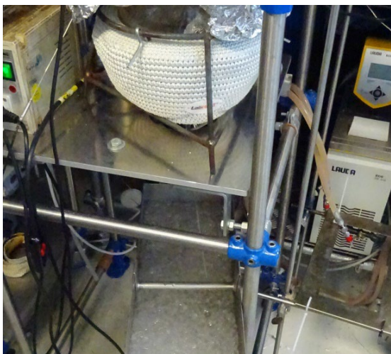
Austrag einer Polycarbonatschmelze aus einem Glaspolykondensationsapparat
