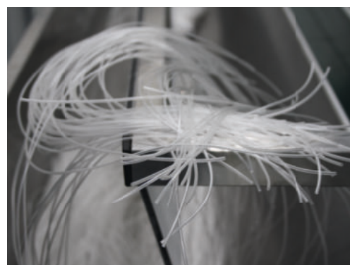
Katheter-Schläuche hergestellt mit Co-Extrusionslinie
