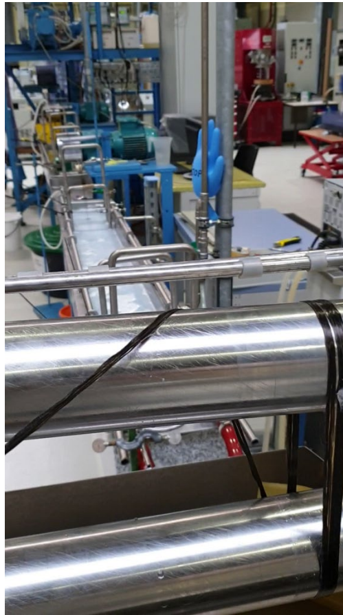
Apparatur zur Strangpräparation für die Gewinnung von Flockfasern aus Basalt
