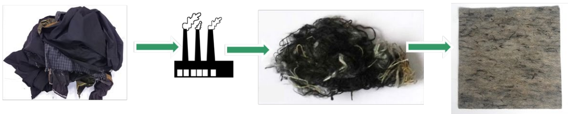
Abbildung - Aufbereitungsstufen von Recyclingfasern für Naturfaserverbundwerkstoffe
