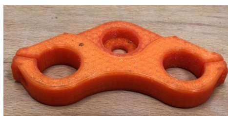
Abbildung 2: Mit BiKo-Filament gedrucktes Maschinenbauteil.
