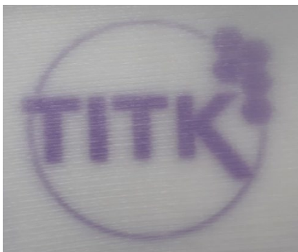
Bild 1: Textil aus photochromen PLA-Garn, teilweise durch Sonnenstrahlung gefärbt
