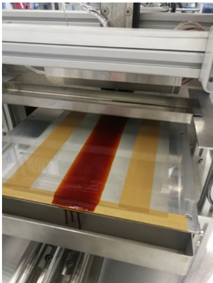
Abb. 1: Gelelektrolytbeschichtung mittels Linearbeschichtungsanlage
