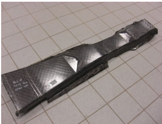
Abbildung – Verbundbauteil mit gewickeltem Stackaufbau
