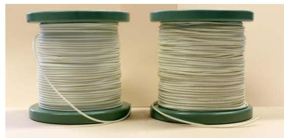
Abbildung 4: antibakteriell ausgerüstete TPU- Katheterschläuche (medical grade)
