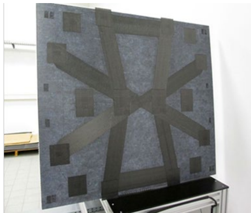
Abbildung – Wabenverbund mit lastpfadspezifischer Deckschicht (Doppelplatte)
