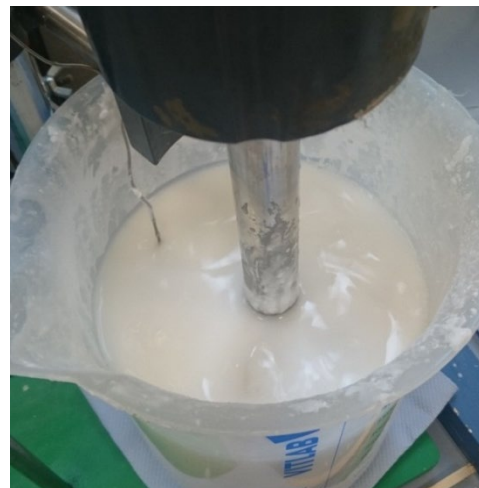
Herstellung eines 62 Ma %-Nacolether 12 / Wasser-Slurries
