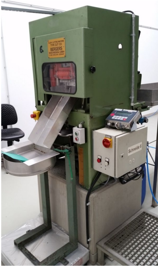
Schneidapparatur zur Herstellung von Flockfasern aus Basalt.
