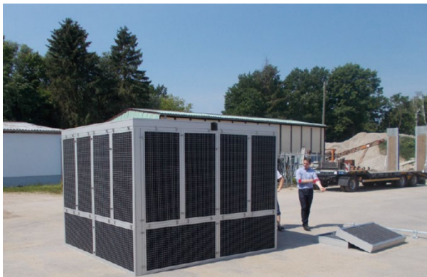
Textiler Demonstrator zur Verminderung von Staub- und Lärmemissionen am Bau (Foto: HuT Oderbau GmbH)
