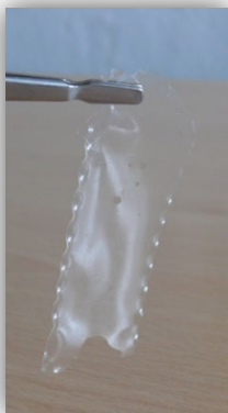
Abb. 1: Ein vernetzter Elektrolytfilm. Abb. 2: Ein Elektrolytfilm auf EC-Polymer beschichteter Folie.
