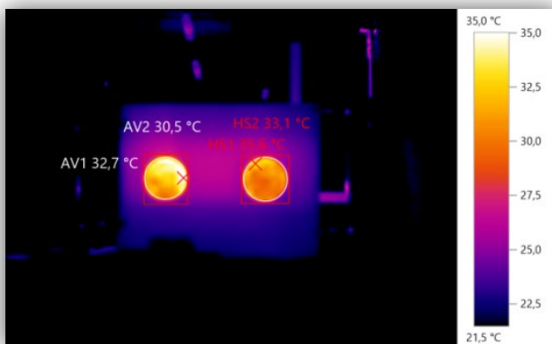
Wärmebildaufnahme zweier Vliese, die mit einem IR-Strahler rückseitig bestrahlt werden.
