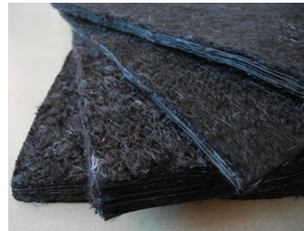
Bild 1: Mit rCF-Vliesauflage genadelte Gelegestacks
