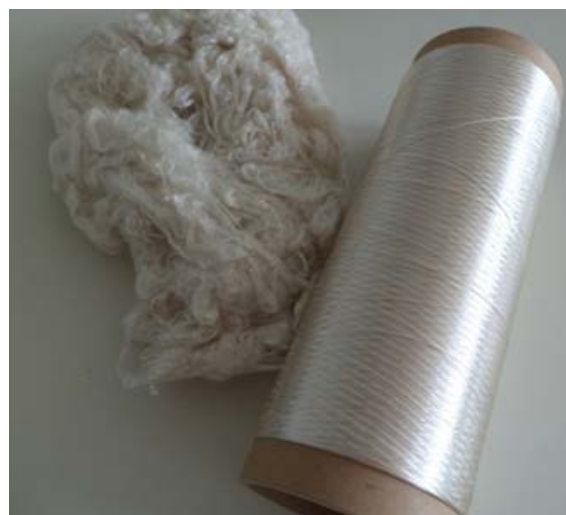
Hergestelltes Faser- und Filamentmaterial aus Batch-Versuchen unter Verwendung eines enzymatisch modifizierten Papierzellstoffes
