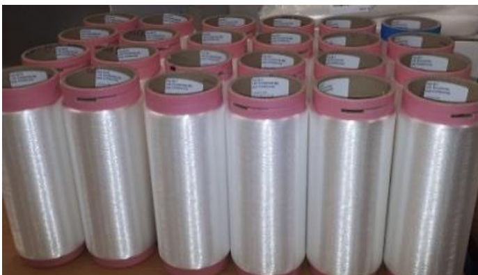
Synthesefaserfilamente mit tribologisch verbesserten Eigenschaften (Hybridgarn).
