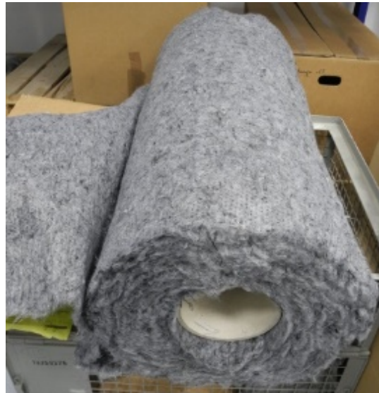
Faservlies 50/50 PA6/rCF aus einer Mattenbildung mittels Speiser, Nadelmaschine und Aufwicklung
