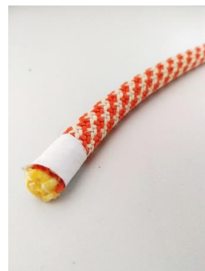
Seilkonstruktion mit eingearbeitetem Hybridgarn. Foto: TU Chemnitz
