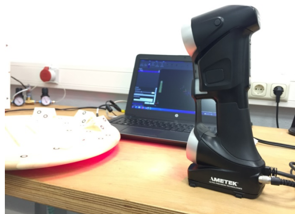
3D-Scanner Creaform Handyscan 300 mit Workstation.
