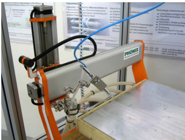
Abbildung 2: Im Projekt angeschaffter Sprühroboter für Spraycoating dünner Schichten
