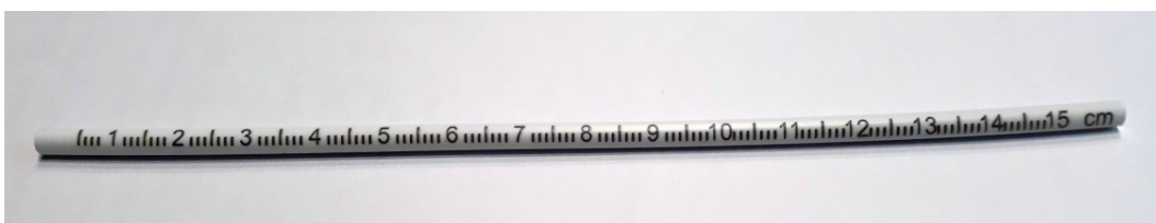
Lasermarkierung eines PVC-Vollkernstabs
