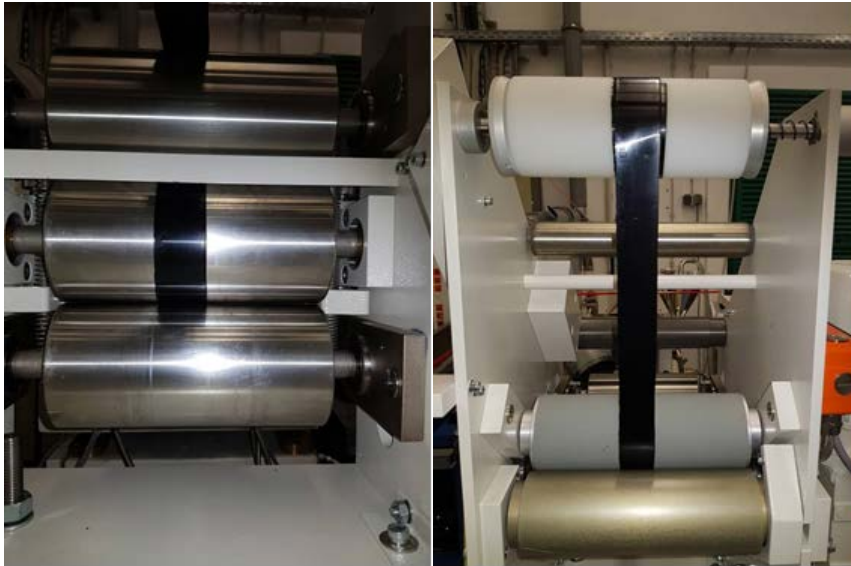
Folienabzug mit beheizbaren Walzen: Kühlwalzen (links) und Aufwicklung (rechts)
