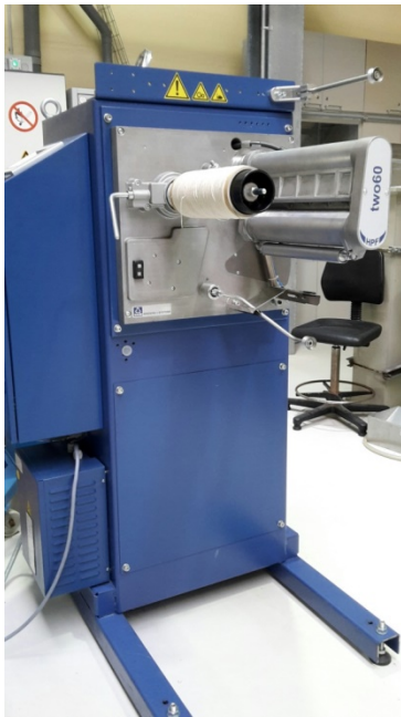
Präzisions-Kreuzspulmaschine Sahn 280XE (links), elektronische Steuerung (rechts).
