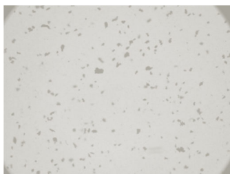
Abbildung 1: Mikrobild der Cellulose/EMIMAc-Lösung E20-25Ag-03 (Hellfeld, polarisiert, 10x)
