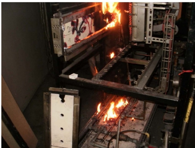
Untersuchung der Bodenbeläge im Kone-Kalorimeter
