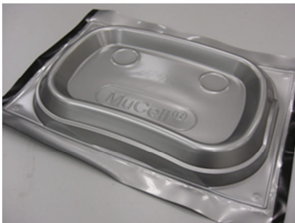
Vorgeformtes Dekor für das Hinterspritzen im MuCell-Prozess
