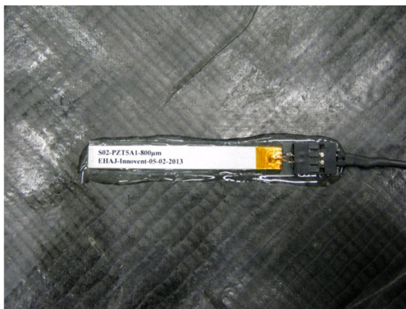
auf Oberfläche eines CFK-Leichtbauteils applizierter PZT-Faser-Sensor
