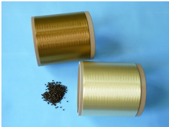
PA 66-Compound und -Multifilamente mit Silberkomplex
