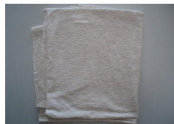
Abbildung 2: Rundstrickschlauch aus Ag-NP- und Baumwollfasern
