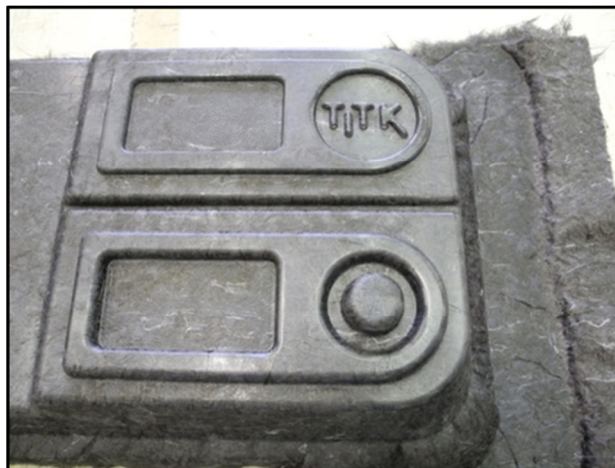
Verpresstes Carbonfaser/ PP-Vlies (ohne Randbeschnitt)
