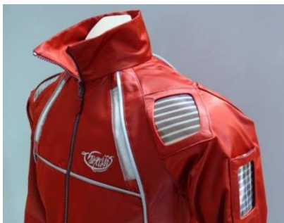
Polymere Solarmodule des TITK auf einer leuchtenden und beheizbaren Jacke der Fa. Richter+partner (Weimar)
