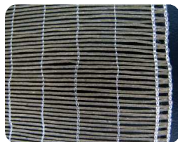
Gewirke aus thermoplastisch verarbeiteten Kollagenmonofilfäden im Querschnitt
