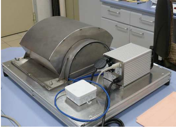
Vorrichtung zur Herstellung definiert gekrümmter Polymerfolien (T: 20°C – 200°C).
