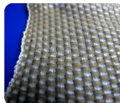
Gewebe aus Kollagenfoliebändchen und thermoplastisch verarbeiteten Kollagenfäden
