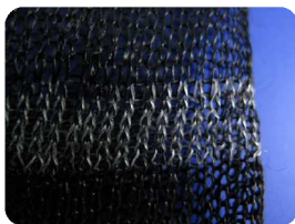
Dreidimensionales textiles Gebilde als Rundgestrick aus nativem Kollagen (mit Hilfsfaden)
