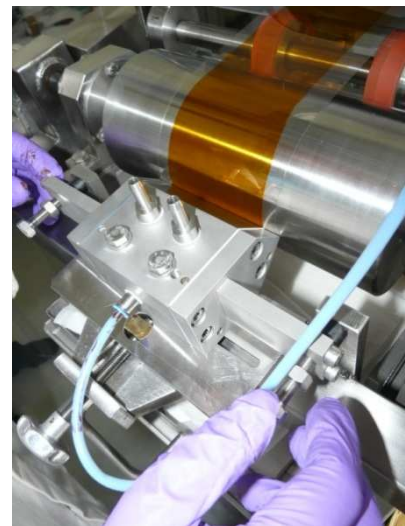
Rolle zu Rolle Beschichtung einer Folie mit fotoaktiver Polymerschicht
