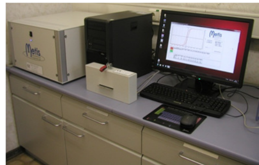
Messplatz zur Untersuchung weichmagnetisch gefüllter Polymere
