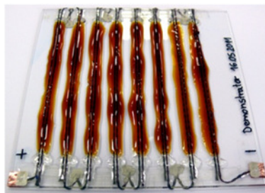
Abb. 2: textiles Demonstratormodul aus 8 Faden-Faden-Solarzellen befüllt mit Gelelektrolyt mit einer Effizienz von 0.77%
