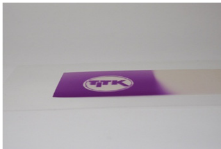
Abb. Rolle-zu-Rolle beschichtete Folie mit photosensibler Sensorschicht: bei Belichtung Farbänderung von farblos nach violett
