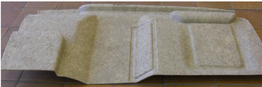
Abb. Dachhimmel-Ausschnitt mit Naturfaserverstärkung
