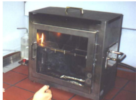
Abb. Brandtest von PAN-Gewebe
