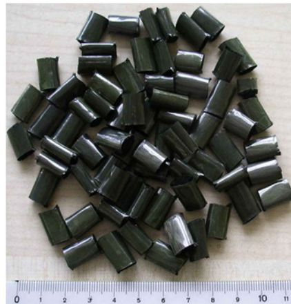
Abb. 2: Hüllgranulate aus CF-Rovingresten 91% CF / 9% LDPE
