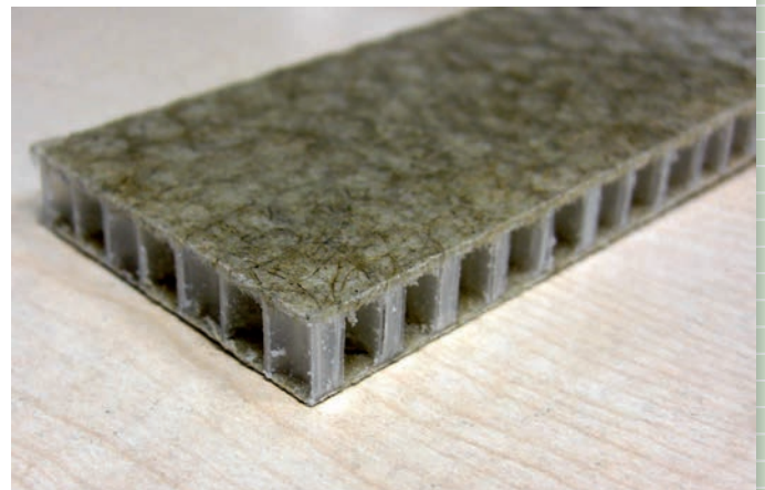
Sandwich mit Naturfaser/PP-Deckschicht und PP-Wabe Sandwich with natural fiber/PP face sheet and PP core
