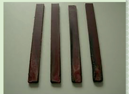
Guss-PA Prüfkörper nach UL94-Brandprüfung. Cast-nylon test samples after flammability test to UL94.
