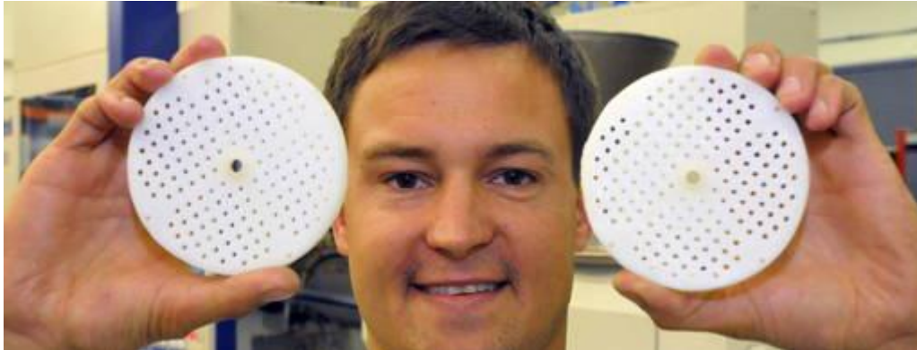
TITK Schwarzta: Mario Willing zeigt Wärmespeicherplatten, die auf einer Spritzgussmaschine aus PCM-Material hergestellt worden sind. Foto: Klaus Moritz
