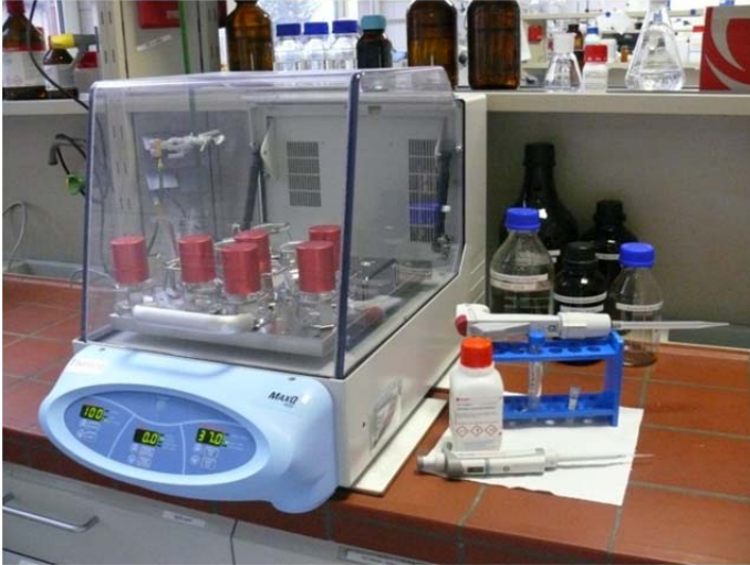
Abb. 1: Enzymatische Behandlung von PET-Varianten im Inkubator
