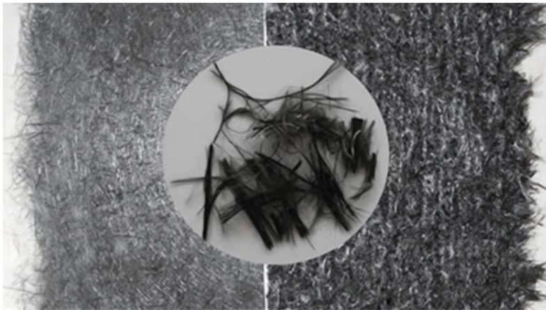
Halbzugmatten aus Recyclingkarbonfasern mit maßgeschneiderten Faserorientierungen für die Verstärkung Kunststoffmatrixen
