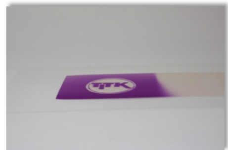
Rolle-zu-Rolle beschichtete Folie mit photosensibler Sensorschicht: bei Belichtung Farbänderung von farblos nach violett
